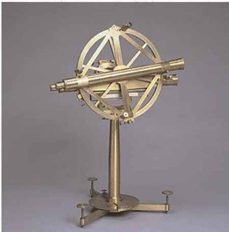
Nom : THEODOLITE (Del. & Méchain) CERCLE REPETITEUR DE BORDA Année : [1790] constructeur : BELLET PARIS (BELLET, gravé sur un rayon). Ce cercle mesure 36 cm de diamètre, les lunettes font 53 et 54 cm. Il porte 2 références de l'Ecole des Ponts et Chaussées : n° 15 RF sur le cercle inférieur et n° 74 sur la lunette supérieure.
