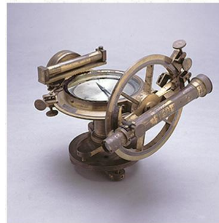
Nom : BOUSSELE THEODOLITE A 2 VIS CALANTES Année : [1800] constructeur :
